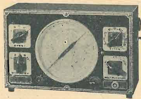
Oscillatore modulato CB III a lettura diretta in metri e kHz. 4 modulazioni di B.F. ecc.
